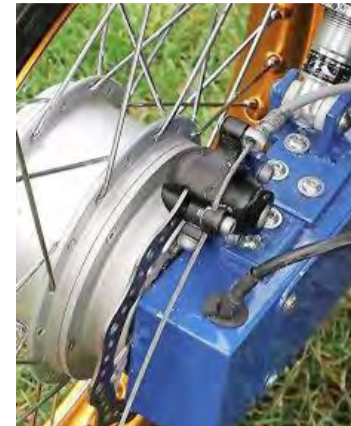
Kompliziert und für Laien nicht leicht nachvollziehbar, Antrieb, Federung und Bremsvorrichtung des „Aktiv-Schiebe-Wagens“ von Peter Sasse.
